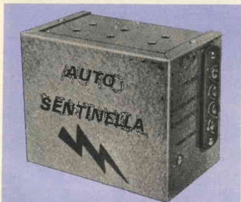
Fig. 3 - Volendo, il sistema d'allarme può essere montato nel cassetto o dietro il cruscotto, cioè dove i collegamenti possono essere convenientemente nascosti o mimetizzati.
