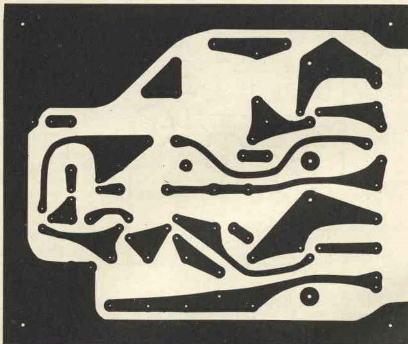
Fig. 3 - Questa figura mostra il circuito stampato in grandezza naturale. Il montaggio può anche essere effettuato con collegamenti da punto a punto su un supporto isolante perforato; in questo caso, però, occorrerà adottare, per i collegamenti e la disposizione delle parti, una buona tecnica costruttiva.
