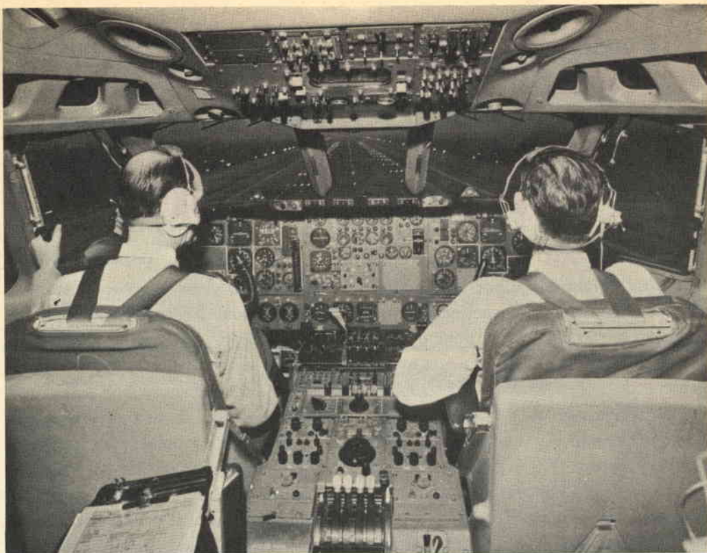
Fig. 2 - Ecco come appare il posto di comando del reattore di linea Super VC10 G-ASGG mentre effettua un atterraggio automatico « senza mani » nell'aeroporto della Royal Aircraft Establishment.
